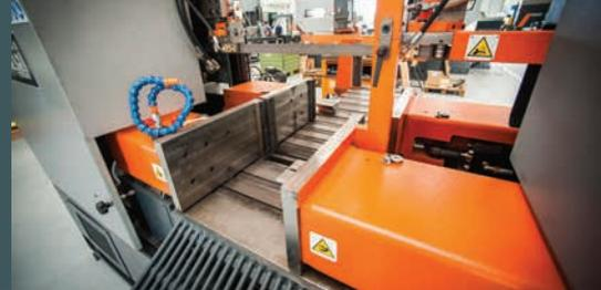
Segatrice orizzontale a due montanti a ciclo automatico per taglio di barre o a pacco destinata a lavori dove è richiesta una elevata produttività; fornisce prestazioni all'avanguardia abbinate ad una estrema precisione di taglio anche negli impieghi più gravosi. La discesa dell'arco avviene per mezzo di cilindro idraulico controllato da valvola proporzionale.
