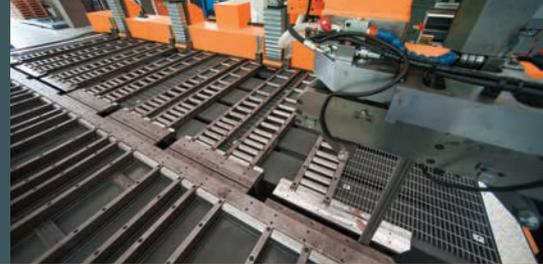
Segatrice a nastro verticale combinata che consente il taglio longitudinale e trasversale. Grazie al guida-lama rotante di cui è dotata le due tipologie di taglio possono essere eseguite senza bisogno di riposizionare il materiale. Un riscontro mobile interno all'arco consente il posizionamento del materiale per il taglio automatico e funge da spintore per il taglio trasversale. Tutti i movimenti di taglio e posizionamento sono eseguiti con motore brushless.
