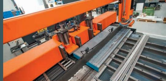
Segatrice a nastro verticale SVL (rifilatrice) per il taglio longitudinale di lastre, lamiere, blocchi. Lo scorrimento dell'arco avviene su guide a ricircolo di sfere e il movimento è ottenuto con motore brushless.
