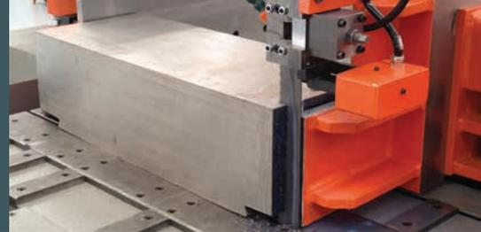
Il punto di forza di questa segatrice verticale ad arco scorrevole è il profondo sbraccio dell'arco portalama, ciò permette il taglio trasversale di larghi piatti utilizzando una lama di dimensioni inferiori rispetto alle segatrici orizzontali poiché viene sempre impiegata nel taglio del lato minore. Il piano è costituito da robusti rulli che sostengono il materiale e ne agevolano l'alimentazione per il posizionamento a misura.
